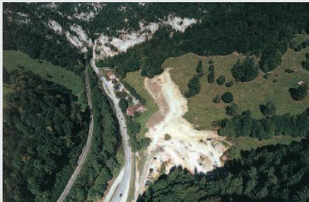
Ce pont sera implanté sur des terrains qui glissent lentement et régulièrement vers l'aval. Les piles seront fondées en profondeur, sur une couche stable, à l'abri de puits de protection ovoïdaux excentrés. Au cours des années, les puits, entraînés par les glissements, peuvent se déplacer contre les piles avec une réserve de 1 m aménagée côté amont. Les pistes de chantier du pont sont actuellement en cours de réalisation.
