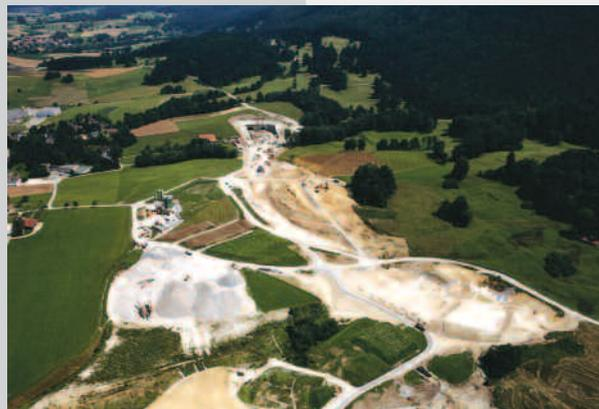
Portail nord du tunnel de Graivery : installation de transbordement pour les matériaux à évacuer en direction de Chaluet.
