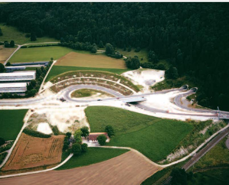
*Les travaux actuellement en cours à Tavannes concernent la jonction de Tavannes, dont la nouvelle configuration a renforcé la sécurité à la sortie du tunnel de Pierre-Pertuis tout en permettant au trafic de chantier d'accéder sans problème à la zone en travaux.*
