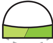
Excavation stross en demi-section
