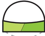
Excavation stross en demi-section
