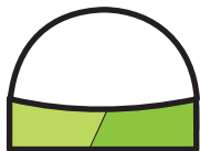
Excavation stross en demi-section
