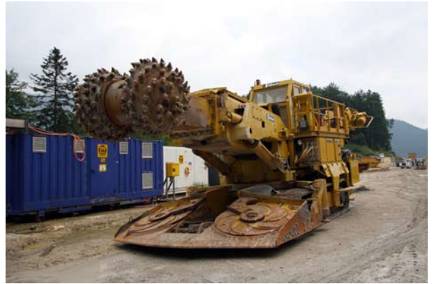
Portail nord: la haveuse prête à démarrer l'excavation (24.05.2007).
