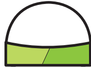
Excavation stross en demi-section
