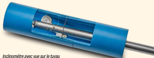
Inclinomètre avec vue sur le tuyau dans lequel coulisse l'instrument de mesure.
